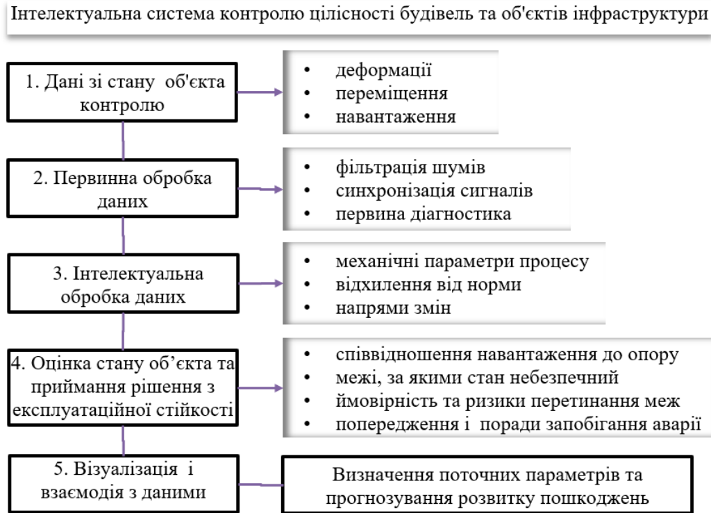
Рисунок 1 – Структурна схема інтелектуальної системи контролю цілісності будівель та об'єктів інфраструктури.
