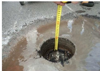
Рисунок 1 - Установа для відбору кернів КП 151-3-02 та висвердлений керн у дорожньому покритті
