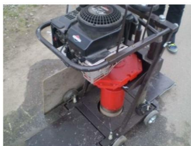
Рисунок 1 - Установа для відбору кернів КП 151-3-02 та висвердлений керн у дорожньому покритті
