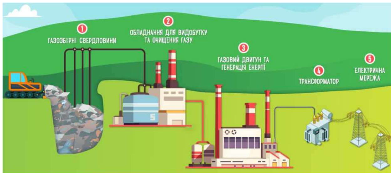
Рис. 4.2. Процес отримання електроенергії з ТПВ
