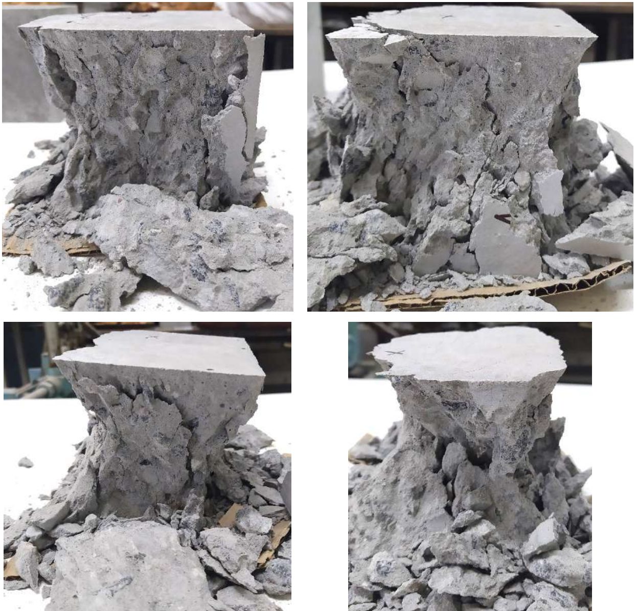
Рисунок 4.10. Характер руйнування зразків з РКЗ
