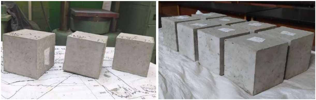
Рисунок 2.6. Готові до випробувань та подрібнення зразки бетону-джерела
