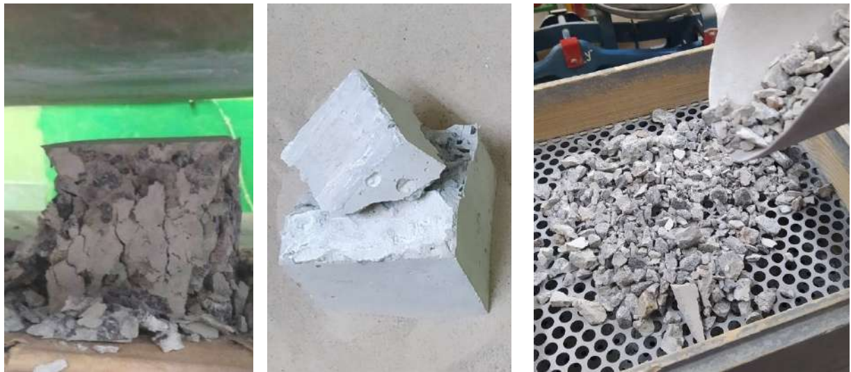
Рисунок 2.8. Зразки до і після подрібнення: а – випробуваний на міцність на пресі зразок бетону-джерела з порушеною структурою; б – розколотий на фрагменти зразок бетону-джерела без порушення структури; в – загальний вигляд суміші рециклінгового щебня одразу після подрібнення
