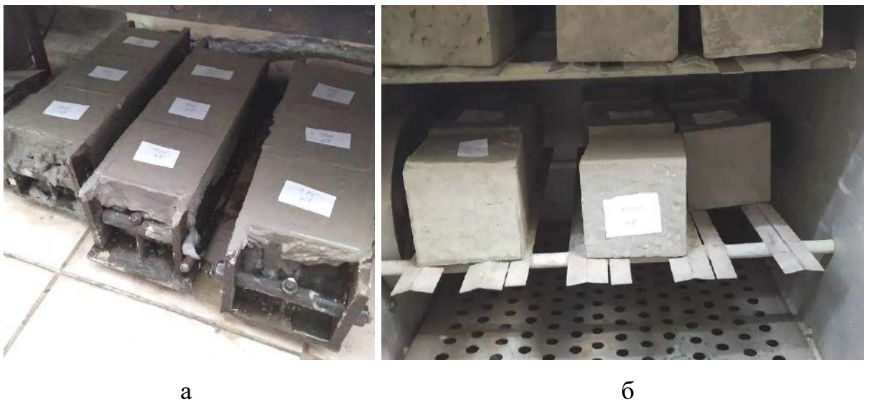
Рисунок 2.5. Зразки бетону-джерела: а – одразу після укладання суміші в форми: б – в сушильній шафі з постійними умовами
