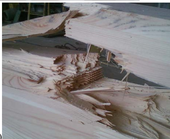
Рис. 3.18. Характер руйнування балки №2
