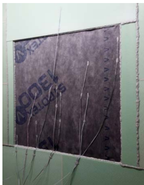
Рис. 4.12. Влаштування датчиків для вимірювання температури на поверхні А – внутрішній блок; Б – зовнішній блок
