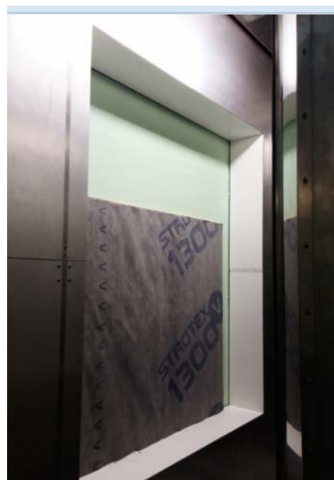
Рис. 4.9. Солом'яно-дерев'яна панель виготовлена для дослідження в кліматичній камері
