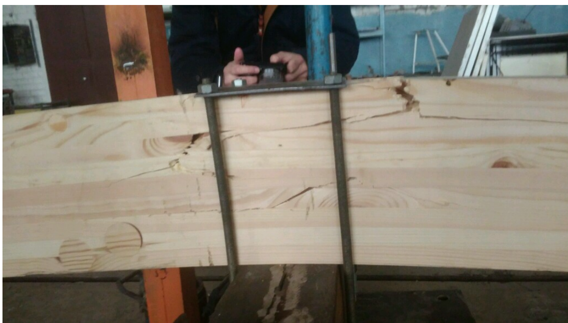
Рис. 3.17. Характер руйнування балки №1
