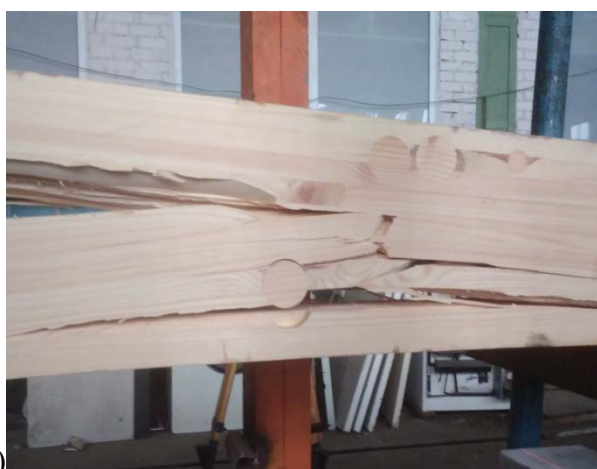
Рис. 3.18. Характер руйнування балки №2
