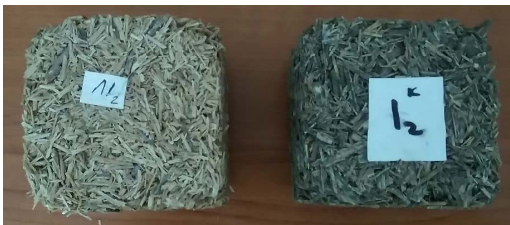
Рис. 4.4. Зразки легких бетонів на основі лляної соломи (Л12) та соломи коноплі (К12)
