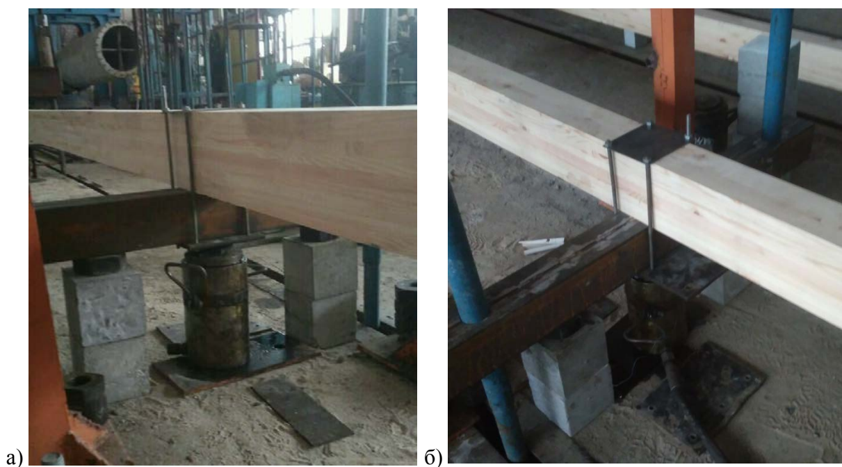
Рис. 3.16. Елементи забезпечення стійкості балки
