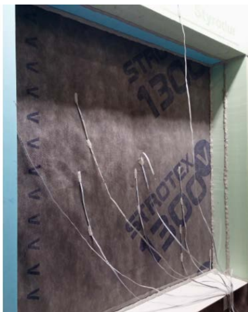
Рис. 4.12. Влаштування датчиків для вимірювання температури на поверхні А – внутрішній блок; Б – зовнішній блок
