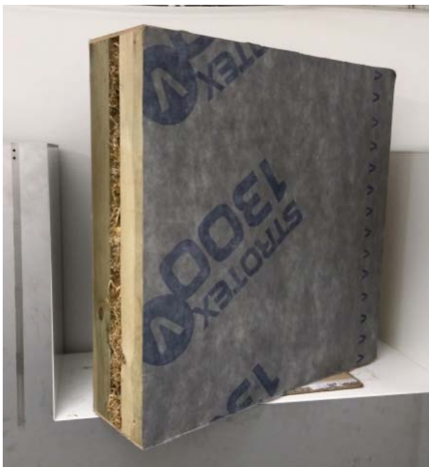
Рис. 4.9. Солом'яно-дерев'яна панель виготовлена для дослідження в кліматичній камері
