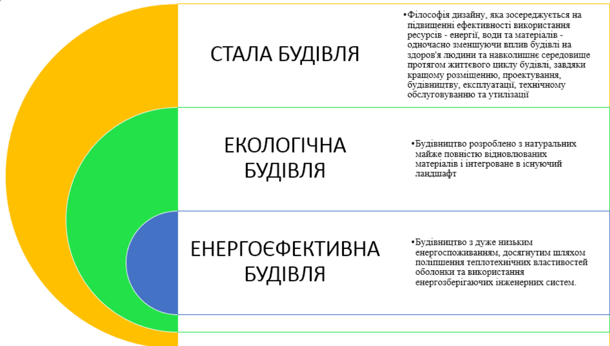
Рис. 1.1. Складові концепції сталого будівництва
