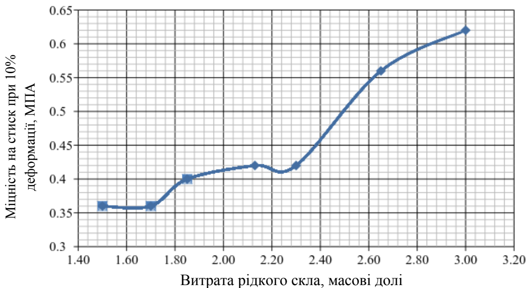
Рис. 4.3. Залежність міцності при стиску при 10% деформації на вміст рідкого скла в суміші
