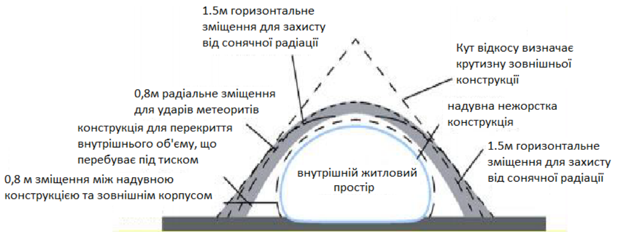
Рис. 1.14. Елементи конструкції місячного житлового модуля
