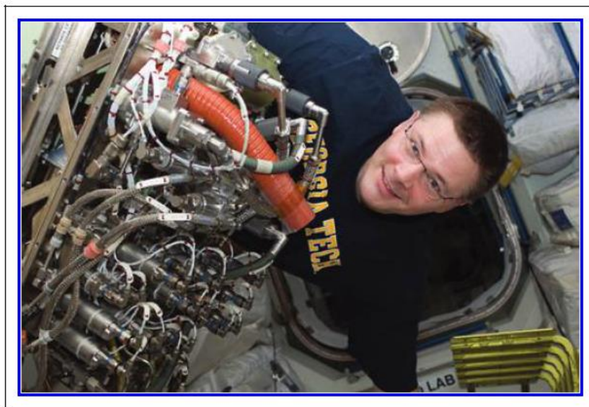
Рис. 2.6. У жовтні 2010 року на борту МКС астронавт NASA і командир 25 експедиції Даг Вілок встановив систему Sabatier, яка витягує більше води з атмосфери МКС. Sabatier створює воду з побічних продуктів установки OGS та вуглекислого газу на станції. Автор зображення: NASA.
