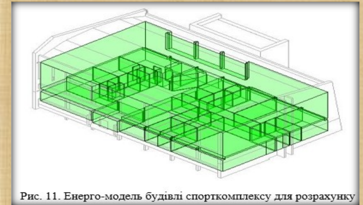
Рис. 11. Енерго-модель будівлі спорткомплексу для розрахунку
