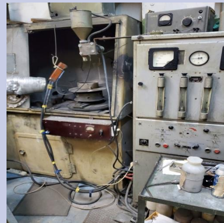
Установка плазмового напилення УПУ-3Д, оснащена плазмотроном ПП-25 та порошковим дозатором роторного типу
