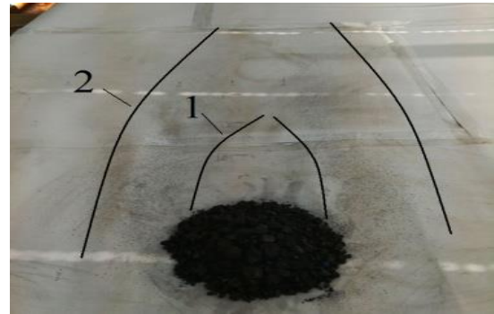
Рисунок 18 – Забруднення робочої зони біля штабеля вугілля (сценарій 1): 1 – область незначного забруднення; 2 – область інтенсивного забруднення.
