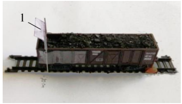
Рисунок 10 – Модель вагона з екраном (додатковий елемент з ухилом «проти потоку»)
