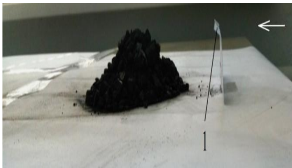
Рисунок 19 – Модель штабеля вугілля з екраном (сценарій 2, додатковий елемент на екрані з ухилом в напрямку штабеля): 1 – екран.
