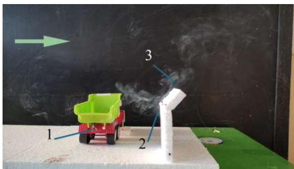
Рисунок 4 – Зона забруднення: 1 – джерело викиду; 2 – зона забруднення перед бар'єром; 3 – зона забруднення над додатковим елементом.
