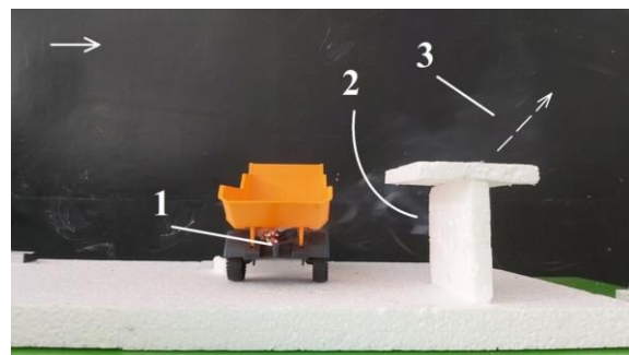
Рисунок 5 – Зона забруднення біля захисного бар'єра: 1 – місце викиду забруднювача; 2 – область забруднення під пластиною; 3 – область забруднення над пластиною.
