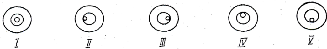
Рис. 16.1. Положення круглого рівня при дослідженні нівелірів з компенсаторами.
