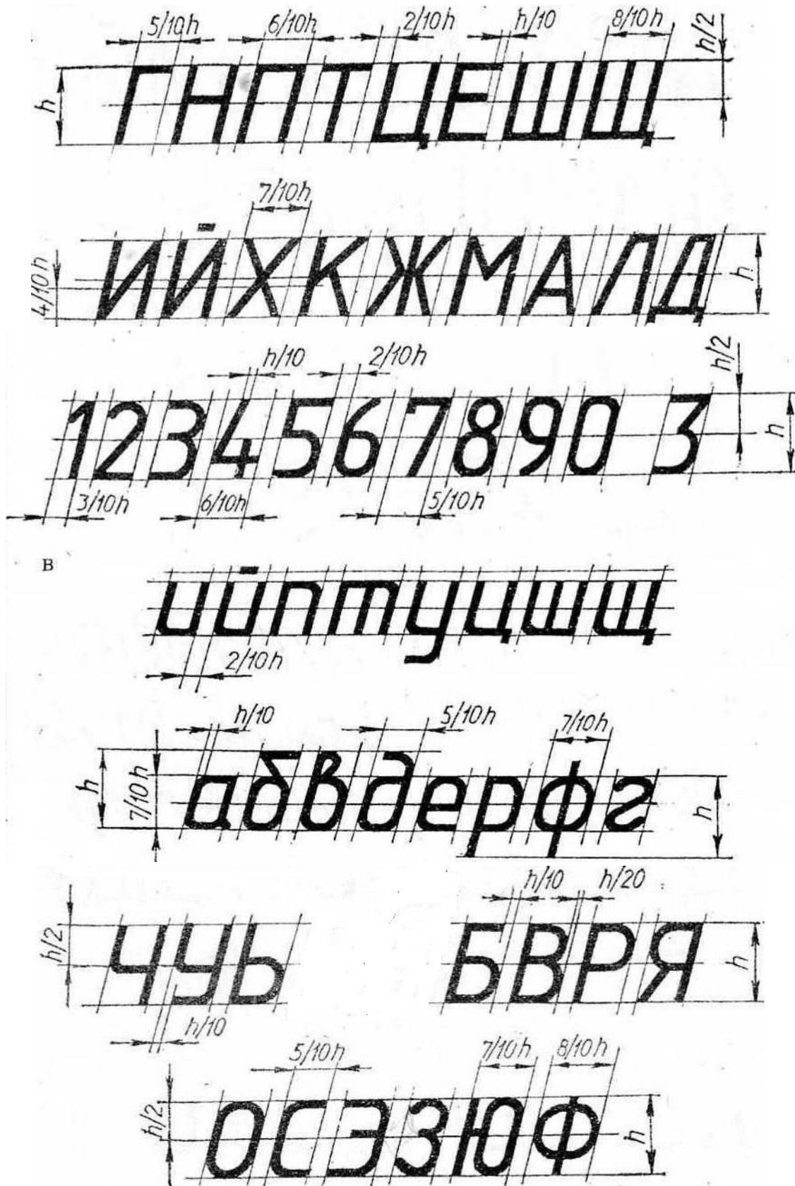
Рис. 2.11. Напис літер та цифр креслярським шрифтом без використання сітки
