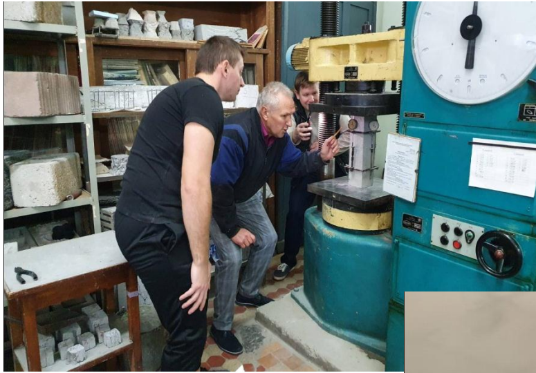
Визначення деформативних характеристик бетонів у лабораторії
