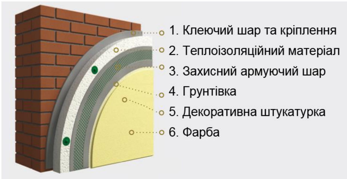
Рисунок 1.1 – Конструкція зовнішніх стін із фасадною теплоізоляцією та опорядженням штукатуркою
