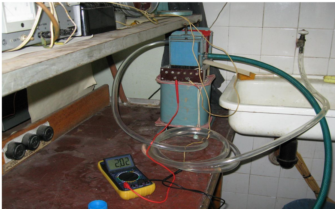
Рисунок 2.3 – Експериментальна установка для електромагнітної обробки концентрованої цементної суспензії для бетонних сумішей
