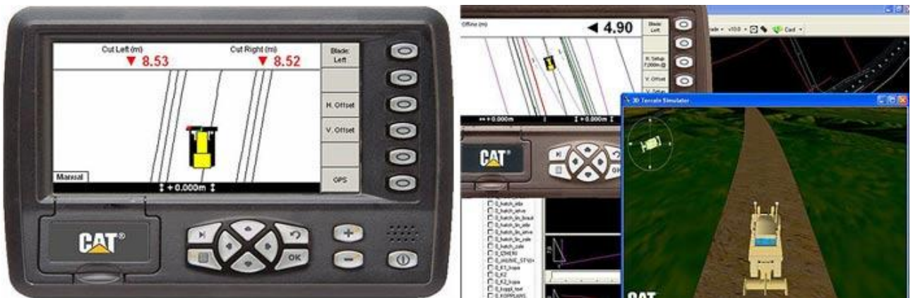
Рис. 3. Супутникове позиціонування бульдозера у просторі
