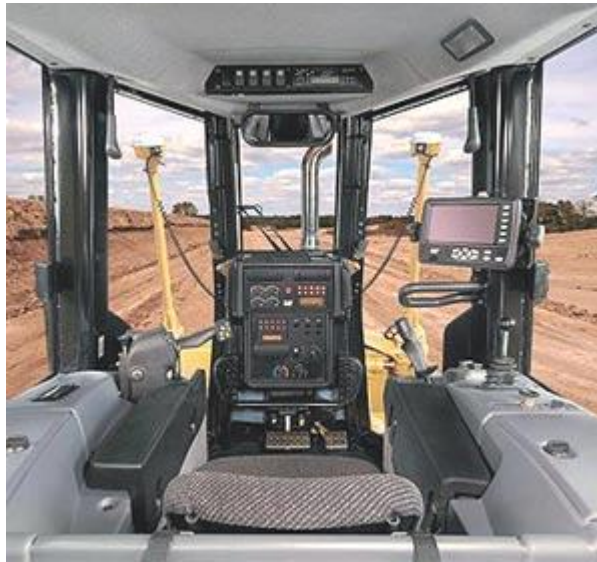
Рис. 1. Кабіна сучасного бульдозера, обладнаного системами просторового позиціонування
