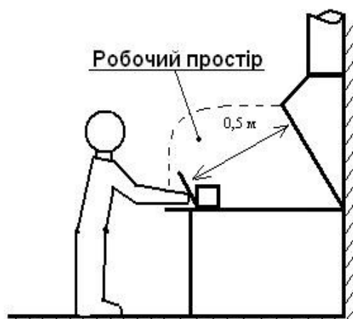
Рисунок 3.3 – Витяжна вентиляція (зонт) на робочому місці зварювальника
