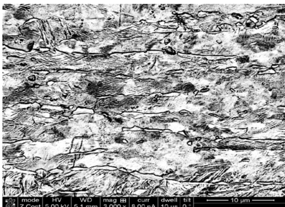
Рисунок 3.4 – Мікроструктура в периферійних областях зразка від труби Ø80x25 мм. першого виробника (у контрасті зворотно розсіяних електронів)
