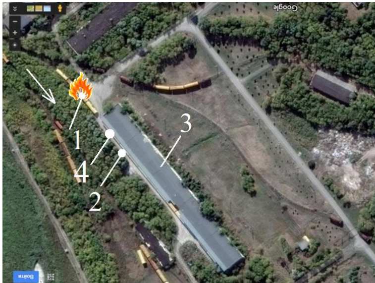
Рисунок 9 – Зона термічного ураження персоналу на промисловому майданчику Павлоградського хімічного заводу (Google image 2019): 1 – місце ймовірного аварійного горіння ракетного палива; 2 – робоча зона № 1; 3 – промислова будівля; 4 – робоча зона № 2.
