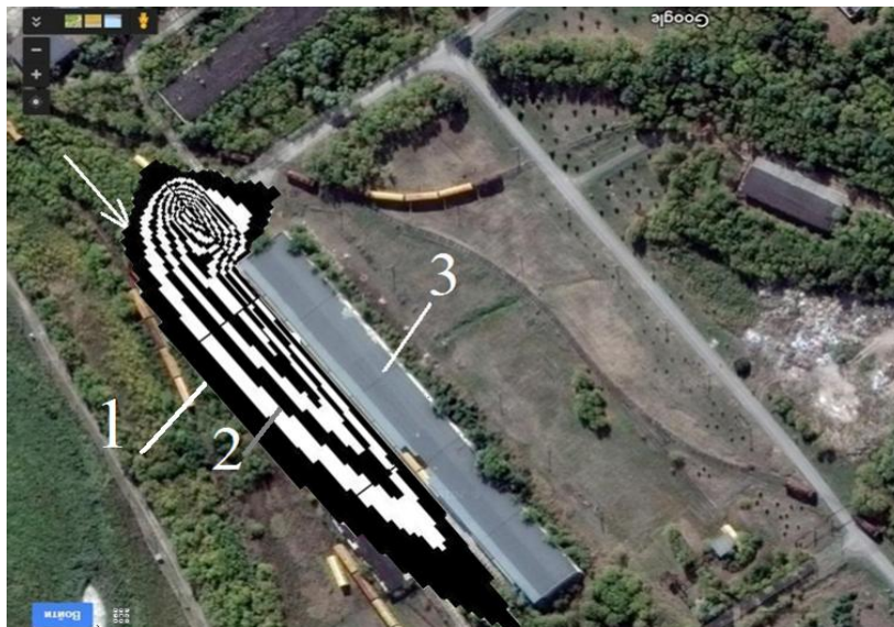
Рисунок 10 – Зона теплового забруднення (ізотерми) біля промислової будівлі, t=32 с: 1 – T=103 °C; 2 – T=240 °C; 3 – промислова будівля.
