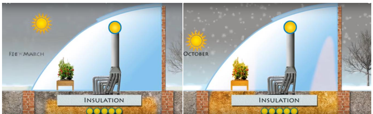
Рисунок 1.8 – Система обігріву канадської геліотеплиці «Groundswell»
