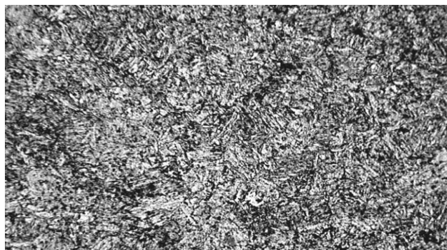
Рисунок 4.11 - Мікроструктура болтів зі сталі 10Г2, х500
