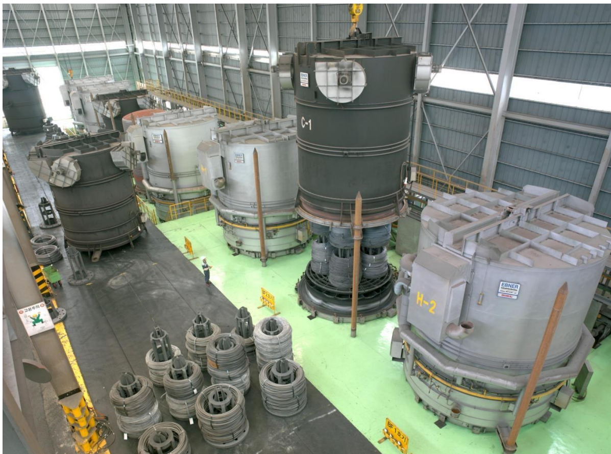
Рисунок 1.2 - Сучасні ковпакові печі для відпалу підкату
