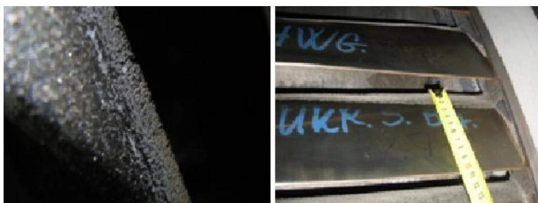
Рисунок 135 – Результати огляду лопаток після 2 років експлуатації: зміцнення електроіскровим легуванням сталлю 15X11МФ-III а – на вхідній кромці; б – на радіусі переходу до поличного бандажу.
