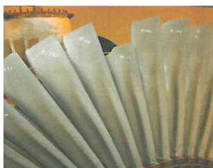
Рисунок 4 – Ротор з відламаною лопаткою
