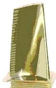
Рисунок 15 - Лопатка, оброблена методом іонної імплантації .
