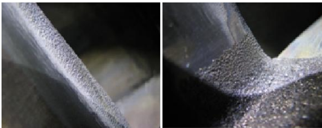
Рисунок 134 – Результати огляду лопаток після 2 років експлуатації: зміцнення СВЧ по перу лопатки і електроіскровим легуванням сталлю 15X11МФ-III радіусного переходу;
