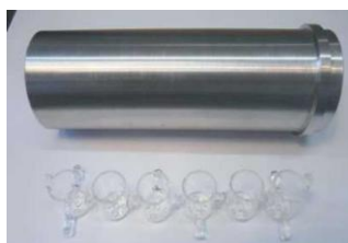
Рисунок 31 – Сталевий автоклав, який використовується в тестах впливу агресивного середовища і зразки стаканчиків
