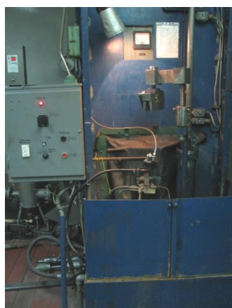
Рисунок 23 – Установка для зміцнення кромки лопатки СВЧ
