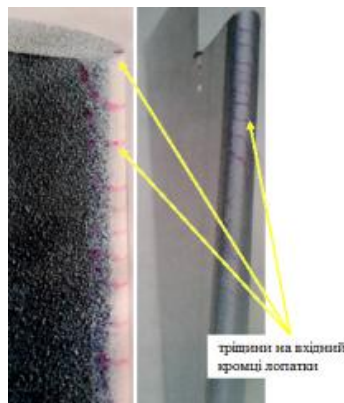
Рисунок 43 – Тріщини на вхідній кромці лопаток
