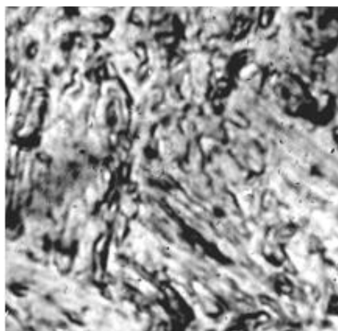
Рисунок 39 – Мікроструктура сталі після гартування 1000 °C та відпуску при 300 °C, \times 1000
