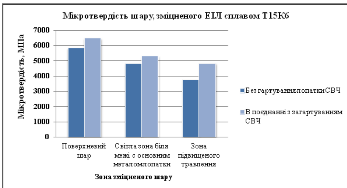
Рисунок 71 – Мікротвердість шару, зміцненого ЕІЛ сплавом Т15К6
