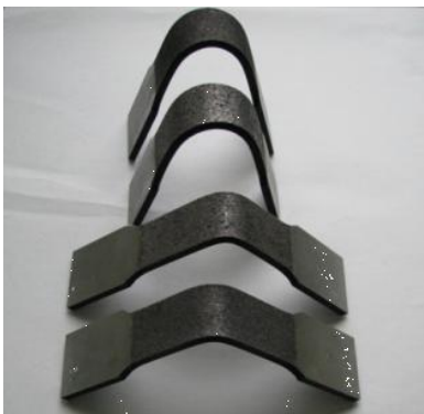
Рисунок 60 – Зразки після випробувань якості зчеплення
