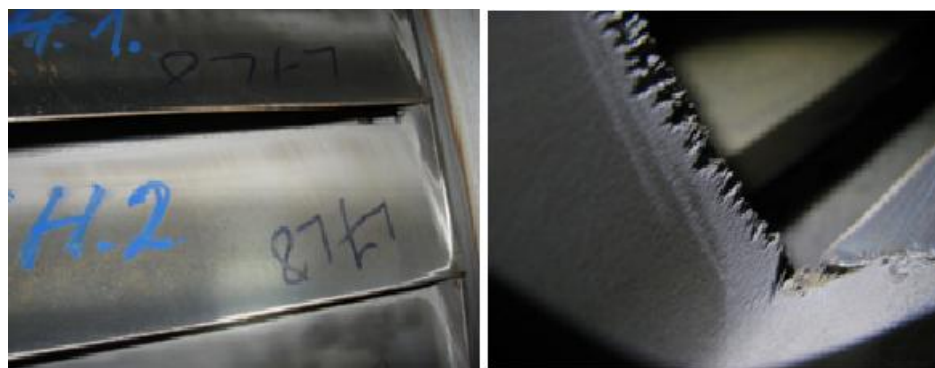
Рисунок 128 – Результати огляду лопаток після 5 місяців експлуатації: напилення виробництва Швейцарія; а – на вхідній кромці; б – на радіусі переходу до поличного бандажу
