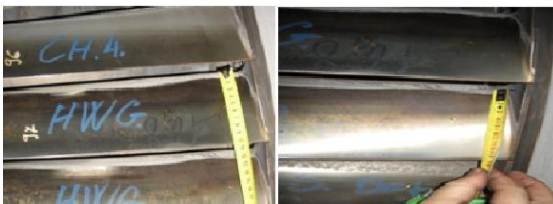
Рисунок 133 – Результати огляду лопаток після 2 років експлуатації: СВЧ виробництва Німеччини.
