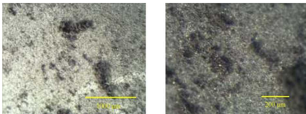
Рисунок 124 – Зображення порошку, відокремленого від поверхні зразка, зміцненого СВЧ
