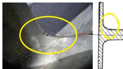
Рисунок 22 – Ерозія на ділянці радіусного переходу до бандажу
