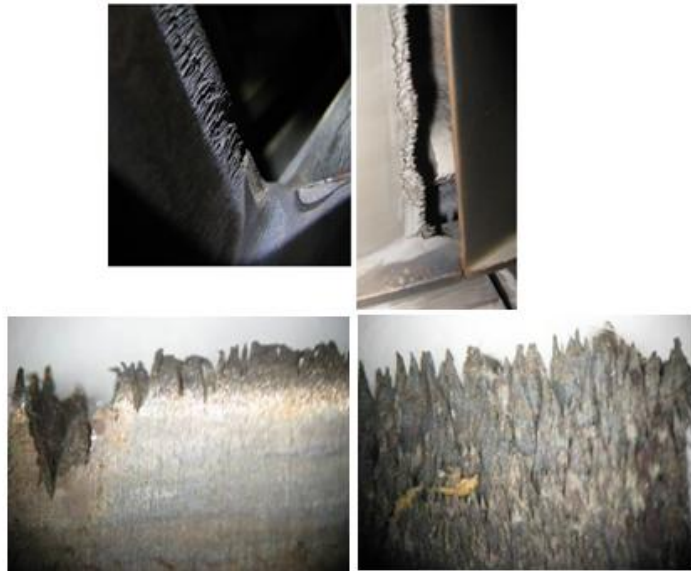
Рисунок 5 – Характерна ерозія вхідних кромek лопаток парової турбіни
