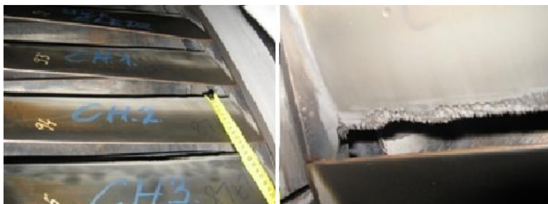
Рисунок 132 – Результати огляду лопаток після 2 років експлуатації: напилення виробництва Швейцарія;
