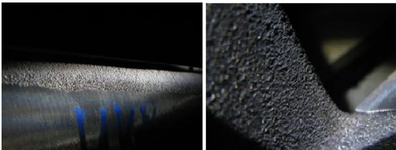
Рисунок 130 – Результати огляду лопаток після 5 місяців експлуатації: електроіскрове легування сталлю 15X11МФ-Ш по всій по всій довжині лопатки; а – на вхідній кромці; б – на радіусі переходу до поличного бандажу
