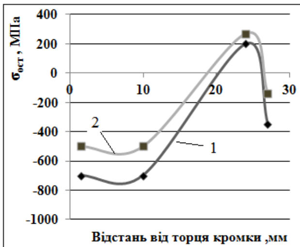
Рисунок 8 – Розподіл залишкових напружень у зміцненому шарі: 1 – гартування СВЧ, 2 – гартування СВЧ і відпуск 330°С
