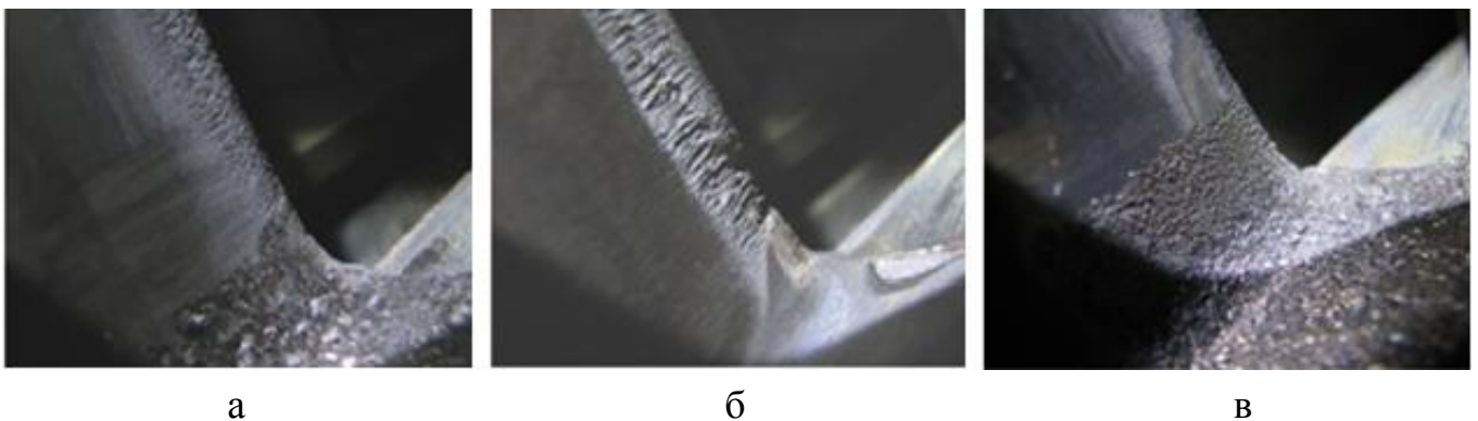
Рисунок 15 – Зовнішній вигляд лопаток на ділянці радіусного переходу після експлуатації: а - зміцнення СВЧ по перу лопатки і електроіскровим легуванням сталлю 15X11МФ-Ш (5 місяців) ; б - зміцнення СВЧ виробництва Німеччини (5 місяців); в - зміцнення СВЧ по перу лопатки і електроіскровим легуванням сталлю 15X11МФ-Ш (2 роки)
