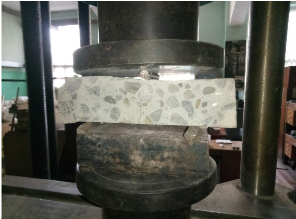
Рис.4. Випробування зразків-балок з фібробетону на пресі УММ-20
