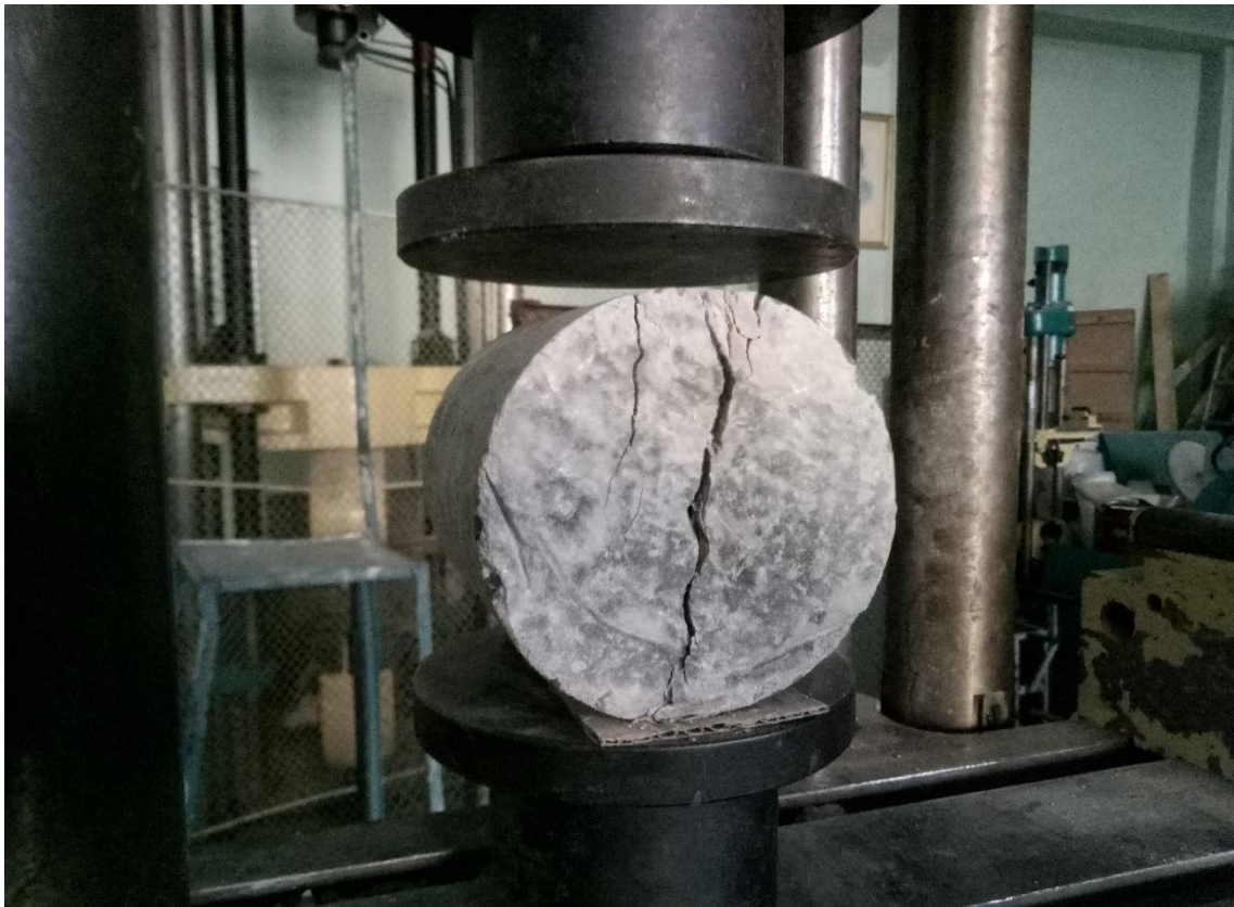
Рис.5. Випробування керну з фібробетону на розколювання на пресі УММ-20
