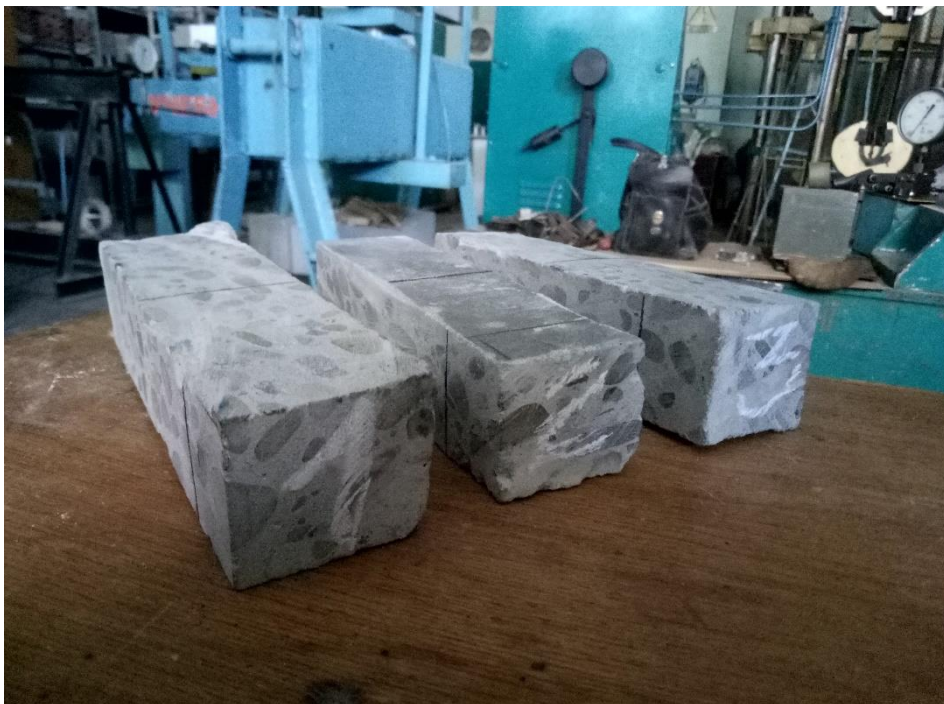
Рис.2.Загальний вигляд зразків-балок з фібробетону для випробування на пресі УММ-20
