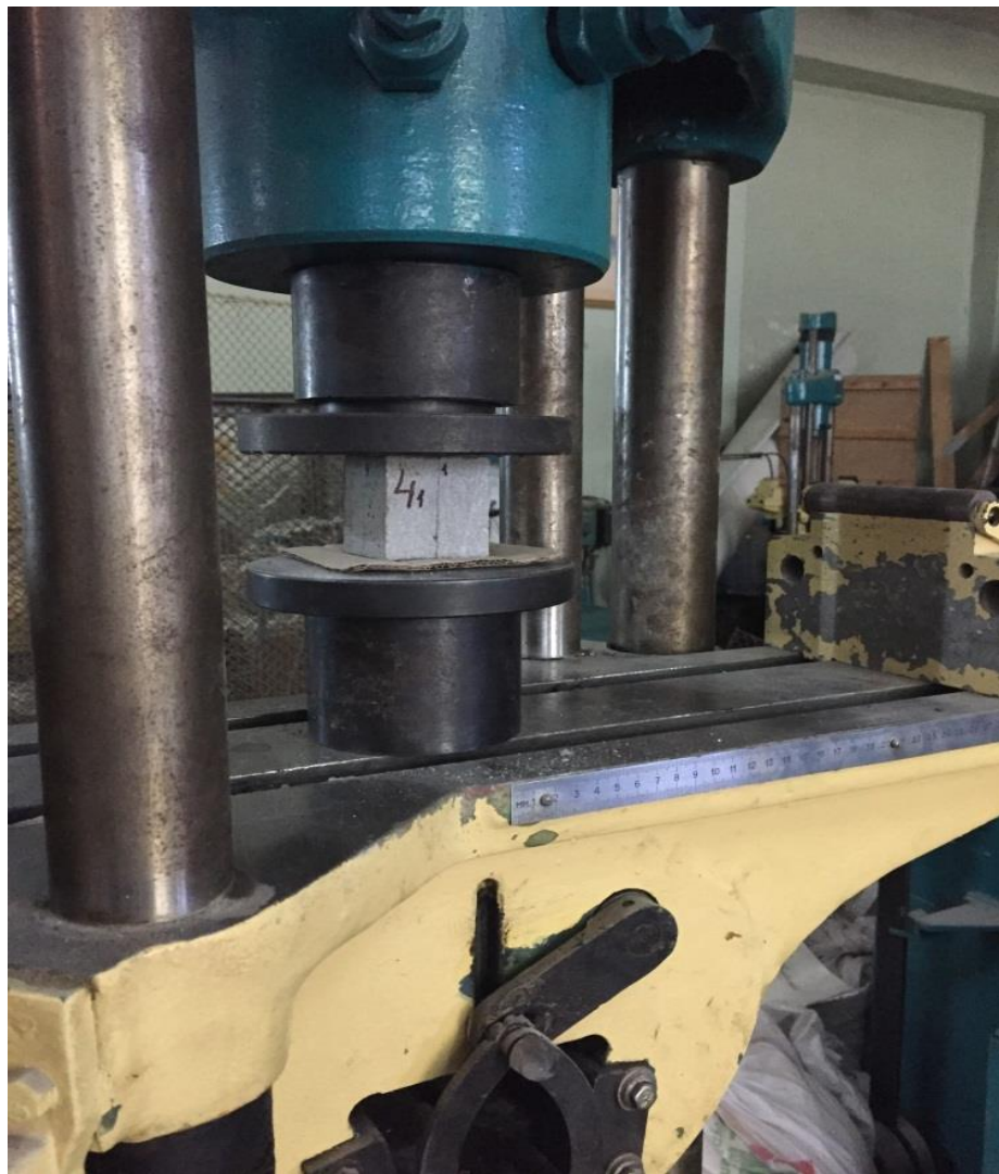
Рис.2. Виробування зразків-кубів на пресі УММ-20
