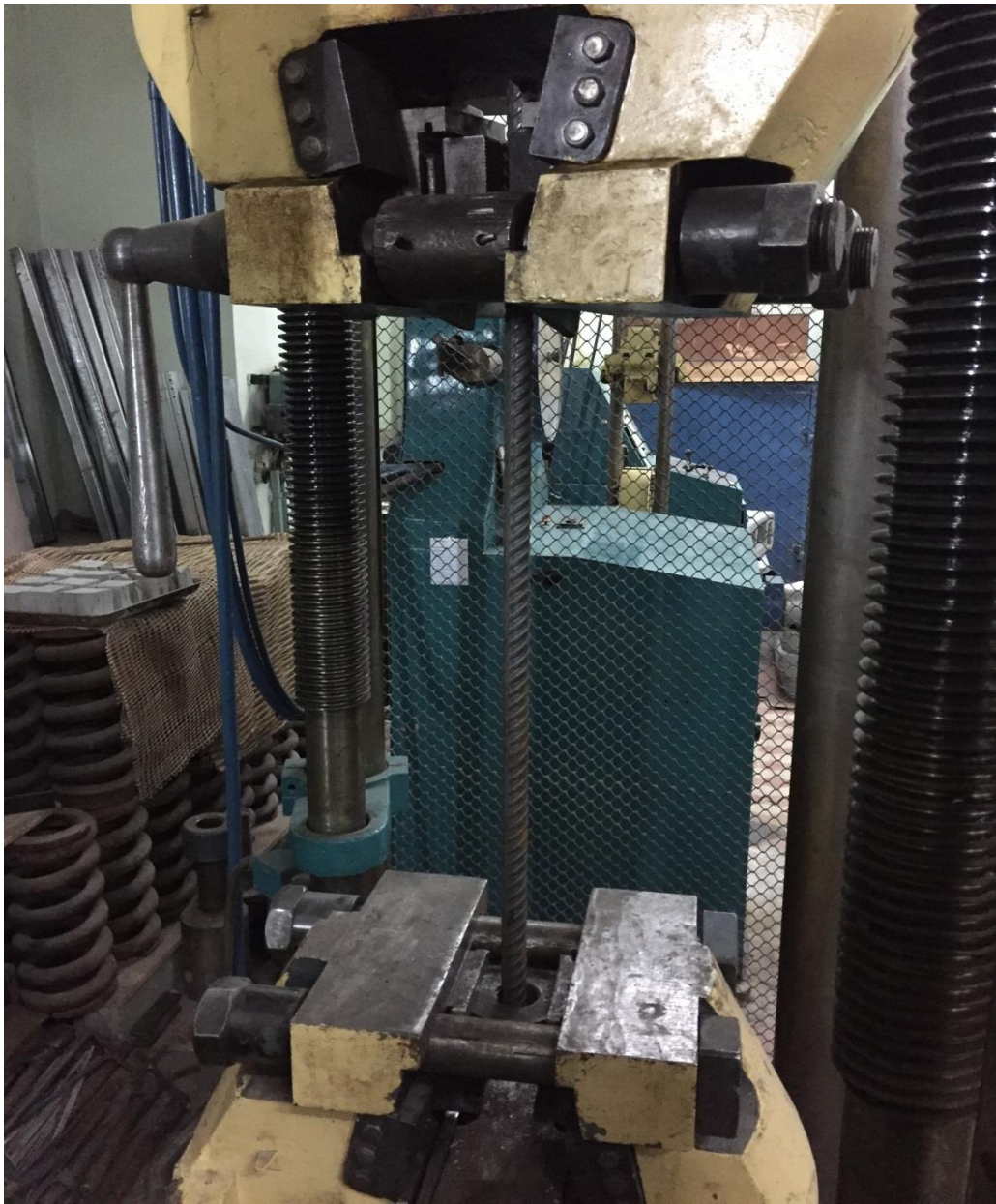
Рис. 10. Випробування арматурного стрижня на розрив на машині ГМС-100
