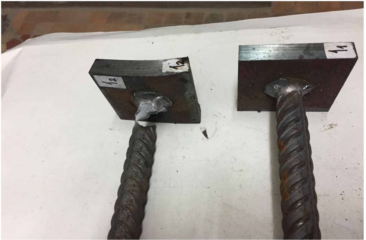
Рис. 11. Дослідження міцності стика арматурного стрижня з металевою пластиною
