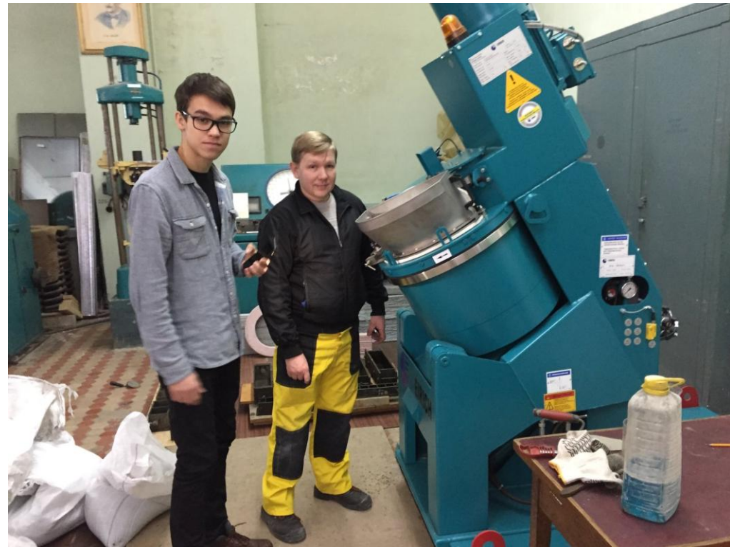
Змішувач Eirich R05T. Розробка оптимальних складів бетонних сумішей для 3D друку
