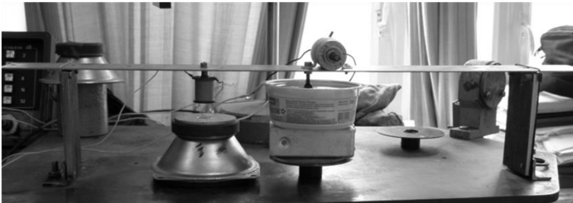
Рисунок 4.10 - Експериментальна установка для вивчення вимушених коливань балки
