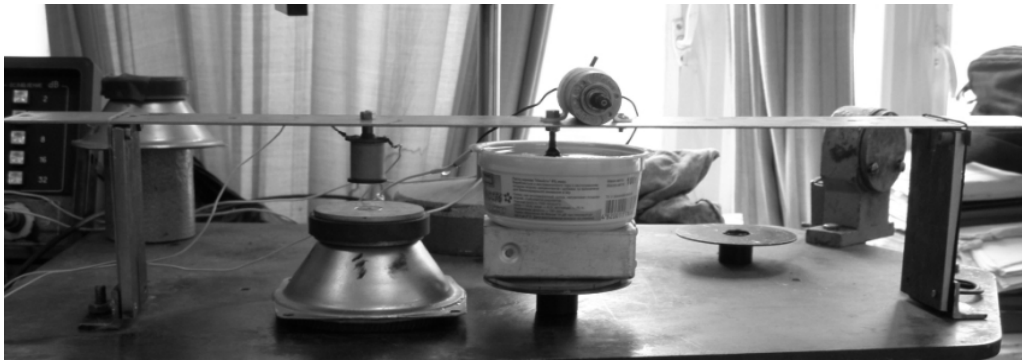
Рисунок 6 - Експериментальна установка для вивчення вимушених коливань балки
