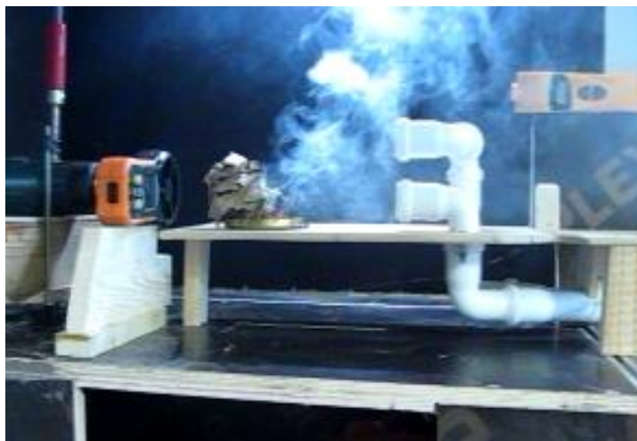
Рисунок 4.5 – Зона забруднення в момент часу t=4 с (витяжний вентилятор не працює, перший етап) [42]
