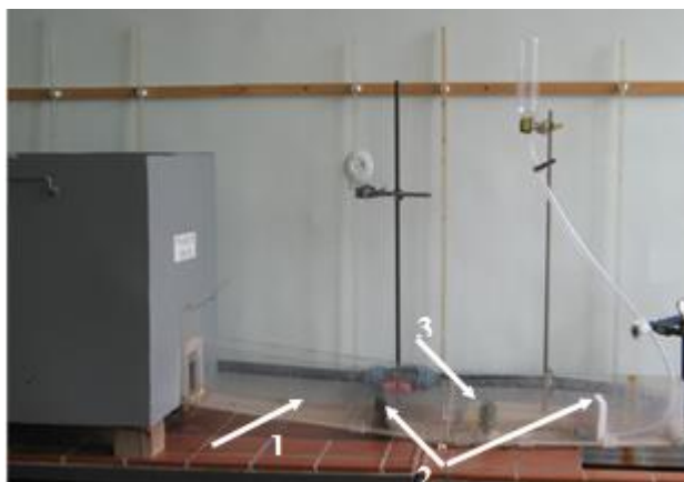
Рисунок 3.20 – Гідравлічний лоток: 1 – жолоб; 2 – водозливи; 3 – модель рослинності
