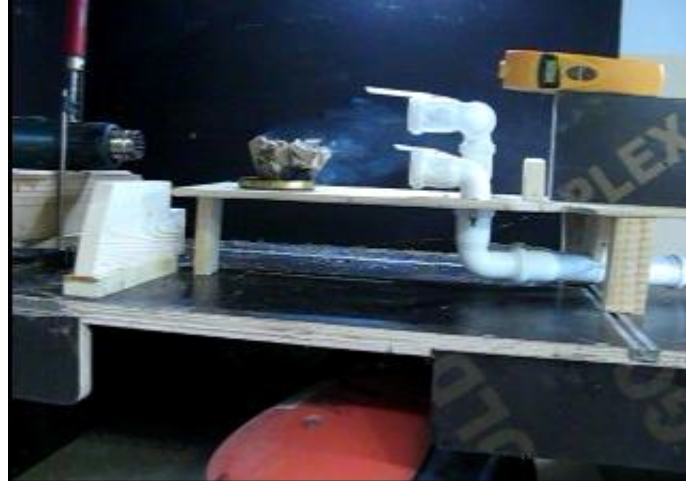
Рисунок 4.16 – Зона забруднення в моменти часу t=14 с (після початку роботи витяжного вентилятора, третій етап)
