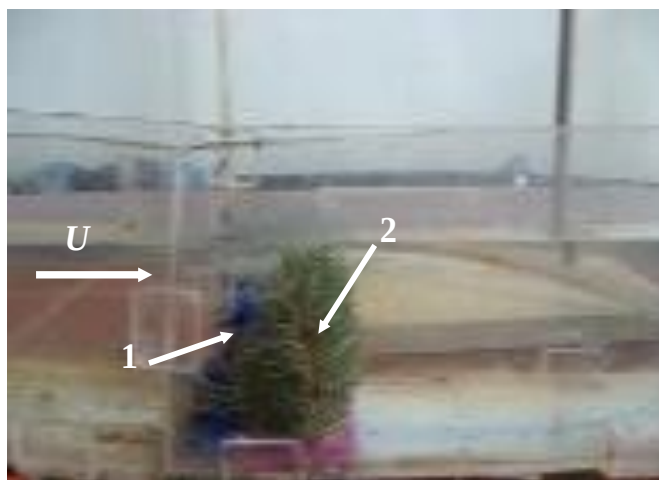
Рисунок 3.25 – Динаміка формування зон забруднення t=4 с при середньому викиді: 1 – зона забруднення; 2 – модель рослинності
