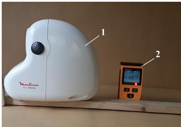
Рисунок 5.6 – Експериментальна установка: 1 – двофазний електродвигун; 2 – прилад для вимірювання напруженості електричного поля
