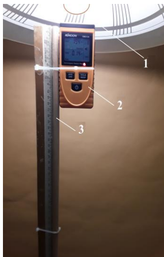
Рисунок 5.7 – Експериментальна установка: 1 – світлодіодна лампа; 2 – прилад для вимірювання напруженості електричного поля; 3 – штатив з вимірювальною лінійкою
