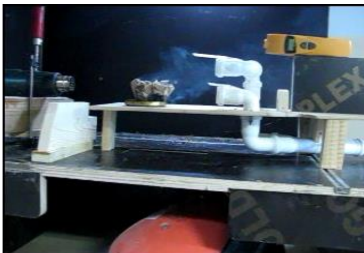
Рисунок 4.15 – Зона забруднення в моменті часу t=8 с (після початку роботи витяжного вентилятора, третій етап)
