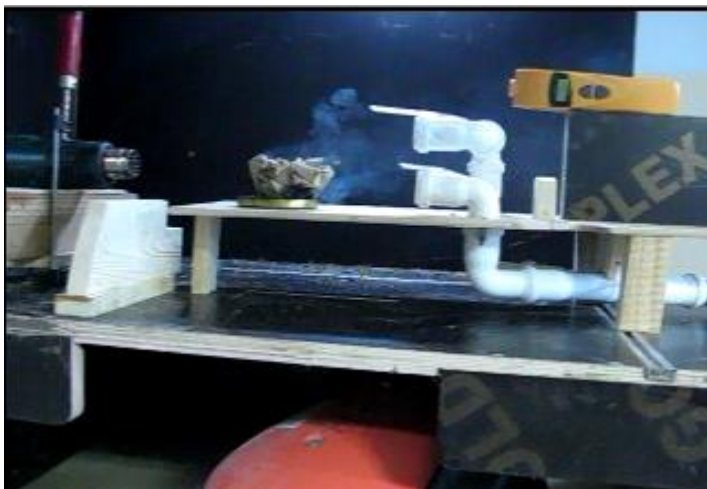
Рисунок 4.14 – Зона забруднення в моменті часу t=4 с (після початку роботи витяжного вентилятора, третій етап)
