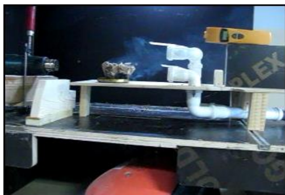
Рисунок 13 – Зона забруднення (розподіл CO ): а – з напрямними пластинами різної довжини; б – з напрямними пластинами різної довжини та екраном
