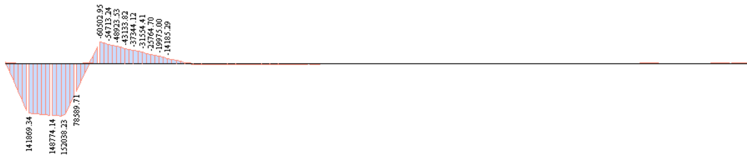
Рисунок 4.27 – Епюра згинального моменту у поздовжній балці від навантаження за схемою №1, Н·м
