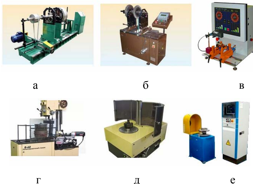
Рисунок А.6 – Дорезонансні балансувальні верстати (з жорсткими опорами): а - верстат 9Д715У (ВКФ «Внешторг-Микрон», Україна) з горизонтальною віссю обертання ротора; б - верстат 9А713Т; в - настільний верстат АТМ-001У (ТОВ «Акрон-3», Росія); г - верстат В-60 з вертикальною віссю обертання («Диамех-2000», Росія); д - верстат В-8; е - верстат VBM 7200 («BALTECH», Росія).
