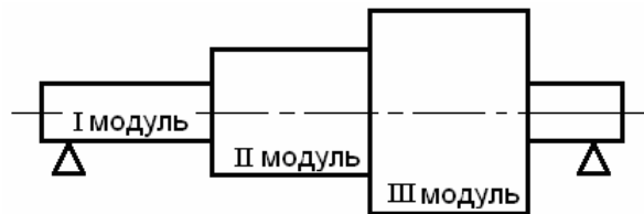
Рисунок А.4 – Схема найпростішої модульної конструкції ротора
