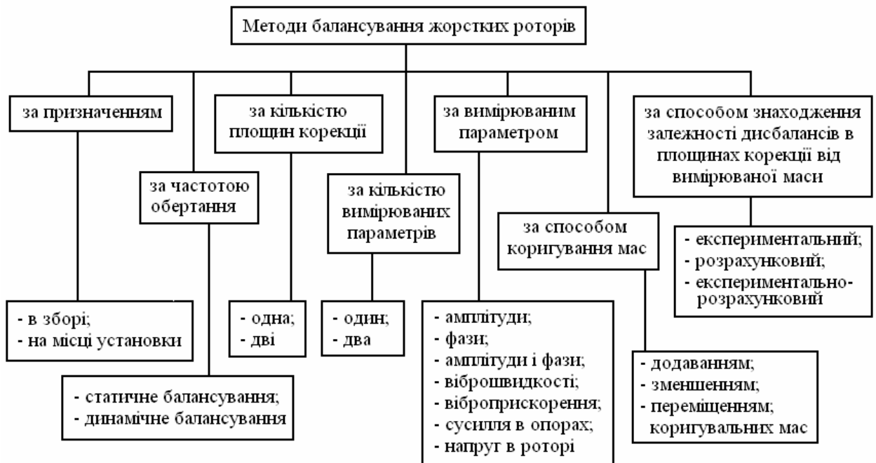
Рисунок 1.7 - Класифікація методів балансування жорстких роторів
