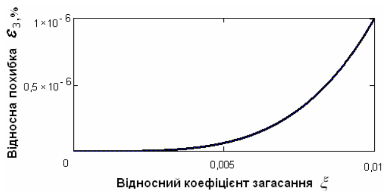
Рисунок 2.7 - Графік залежності відносної похибки \varepsilon_3 модуля головного вектора дисбалансів від відносного коефіцієнта загасання \xi для запропонованого пристрою
