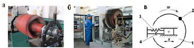
Рис. 3. Современные средства для динамической балансировки жестких роторов: а и б – внешний вид рабочих мест; в – упрощенная схема дорезонансного и резонансного балансировочных станков; 1 – ротор; 2 – неуравновешенная масса; 3 – упругий элемент; 4 – эквивалент трения
